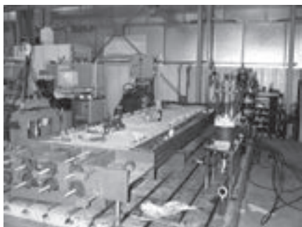
Equipement pour essais dans béton fissuré
